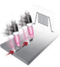
Permet de focaliser l'action et d'obtenir une meilleure stabilité de l'arc électrique.
