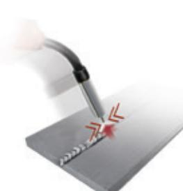
Grâce à cette fonction spéciale, on obtient la brûlure programmée du fil (procédé anti-collage) et la parfaite préparation du fil pour l'amorçage suivant.
